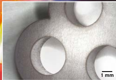
4 mm厚までの金属シートへの精密加工 (4-mm-ステンレス) - 少テーパー/シャープエッジ
