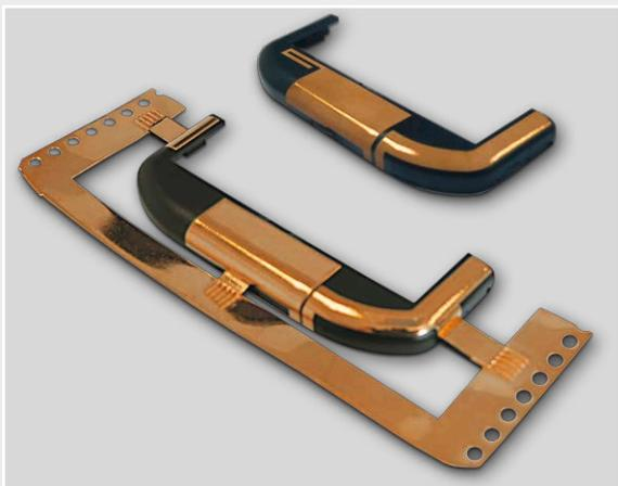
短時間の無電解銅浴後、電解めっきにて銅膜厚を35 $\mu$ mに
