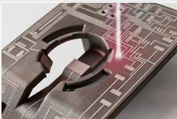
3. Strukturieren der Leiterbahnen mit dem LPKF ProtoLaser 3D
