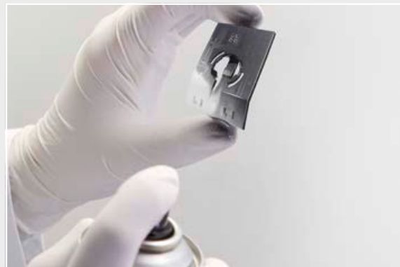
2. Lackieren des Grundkörpers mit LPKF ProtoPaint LDS
