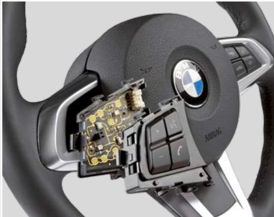
Lenkradbedienelemente (Hersteller: TRW Automotive für BMW)
