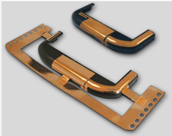
Nach kurzer chemischer Metallisierung entsteht durch klassische Galvanisierung eine glatte, bis zu 35 µm dicke Kupferschicht
